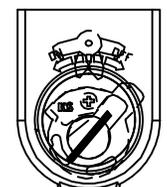
Clé et cames représentées en position « OFF » (inactif)
