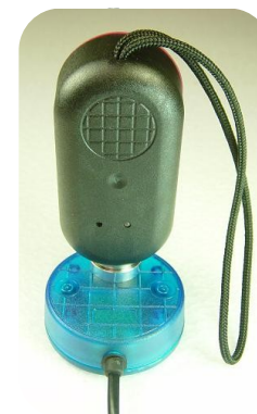
Descarga del M8000-RB via P8000
